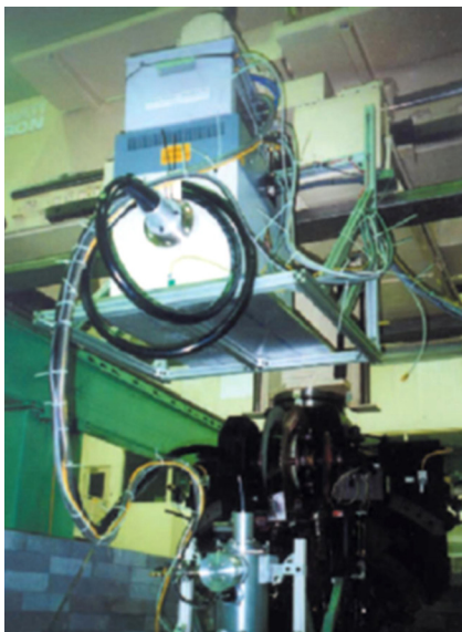
图6 低能电子束源
