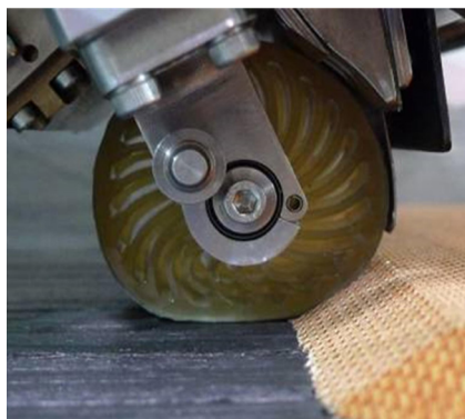
图2 自动铺丝压紧机构 Fig.2 Compacting roller of AFP head
